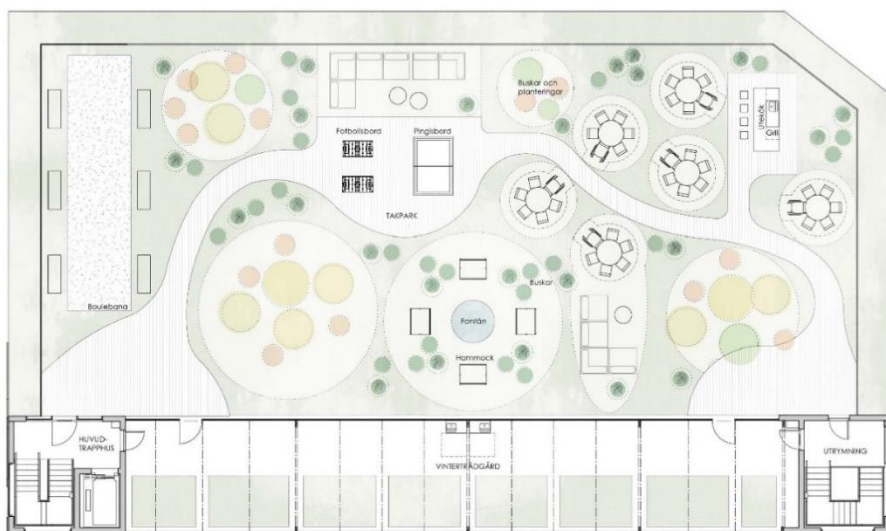
Figur 17. Takterrass ovanpå parkeringshuset som också utgör viktig dagvattenfördröjning.
